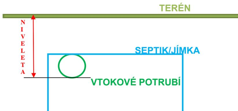
b) Niveleta potrubí v místě odtoku z nemovitosti
